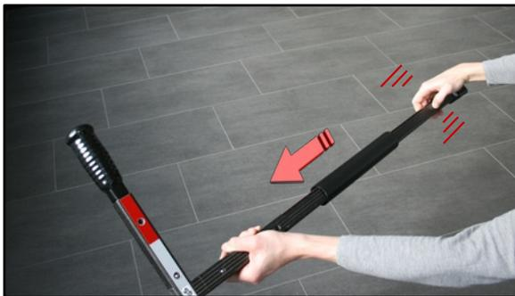
Ziehen Sie das Schutzrohr nach oben. Drücken Sie beide Rastnasen des oberen Druckstücks des unteren Verlängerungsgestänges zusammen und schieben Sie gleichzeitig den Betätigungsschlüssel am Quergriff nach oben.
